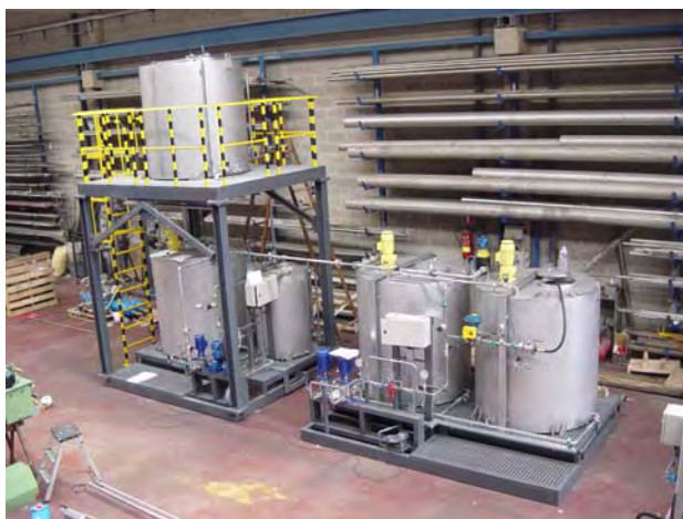
Sistema de emulsionado Agua+Quaker "riego Skin-pass" - Arcelor
