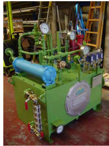
Diseño y desarrollo, central de lubricación para bomba en P. Desalación Rabigh – Arabia Saudí
