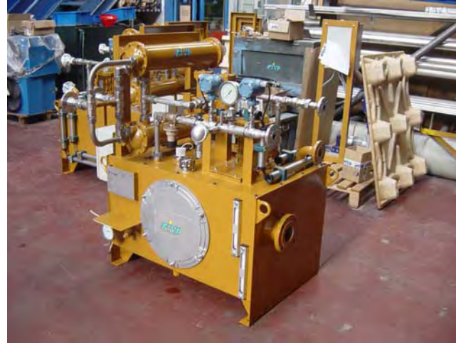
Diseño y desarrollo, central de lubricación para bomba en C. Térmica Tracy – Reno (Nevada – USA), LG Constructors
