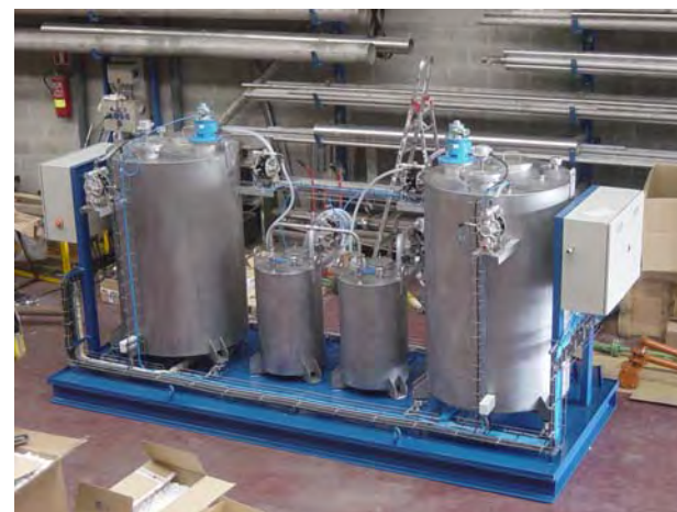
Sistema de preparación químico – Siemens VAI Metals Techn.
