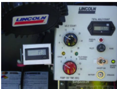
Instrumentación maniobra sistema llenado automático
