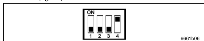
Fig. 10 Interruptor DIP; Sistemas de lubricación PMA - Ajuste
