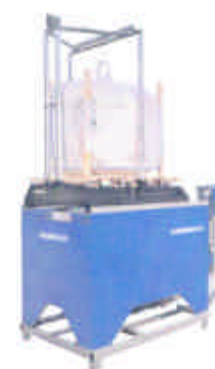
Bolsas de 900 kg conectadas a deposito fijo.
